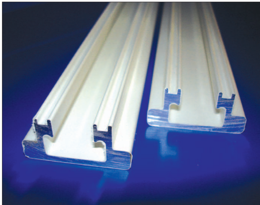
Ytbehandlad fasskena med termoplasten Rilsan för elisolering – ett uppdrag som Korroterm har haft i 25 år för ABB Kabelkonsults räkning.
