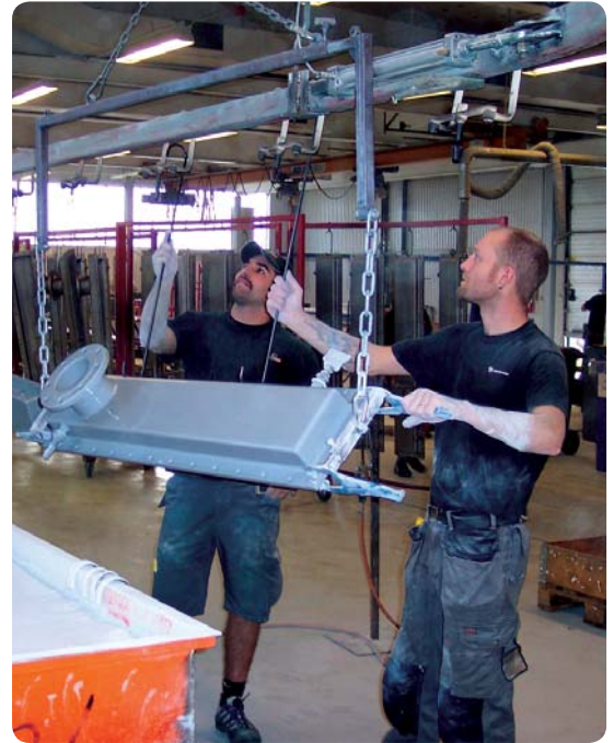
Martin Karlsson och Charlie Rehn hänger upp en kammare som precis belagts med termoplast. Kammaren ingår som en del i en värmväxlare till Coiltech.
